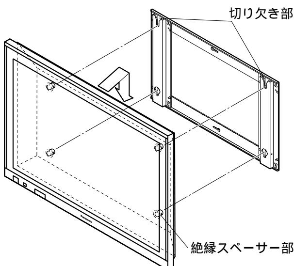
ディスプレイ本体上側の絶縁スペーサー部を壁掛け金具本体の上部切り欠き部に押しあてて引っ掛け、そのまま下へ下げます。
