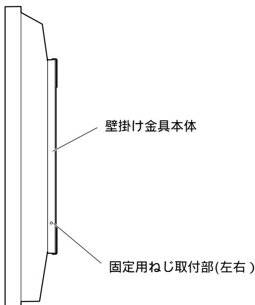
仮止めした左右の固定用ねじを締め付けます。
