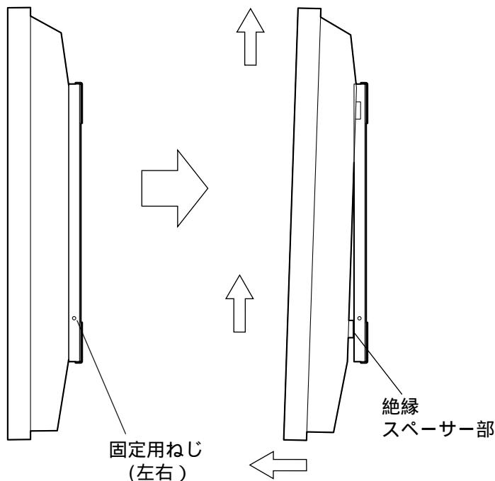
1. 壁掛け金具側面に取り付けられている固定用ねじ(2本)を取り外します。
