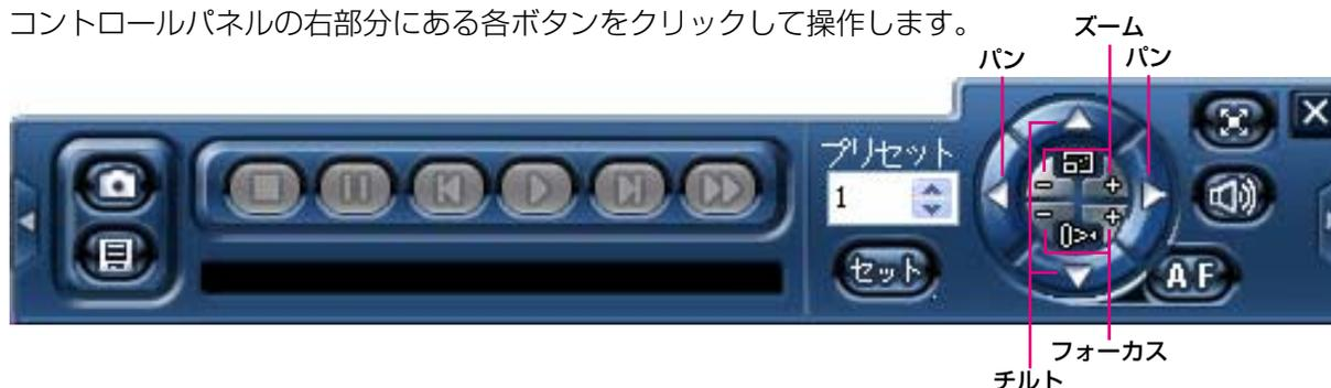
パン・チルト : カメラ画像の水平／垂直位置を調節します。
