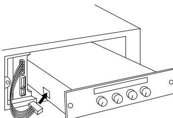
本機を途中まで組み込み、接続コネクタ(付属品)の片側を接続します。
