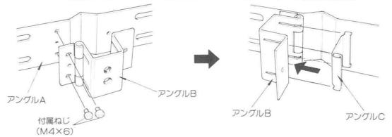
②高さ調整ねじを先に取付けます。譜面台のパイプをアングルAとCではさみ込み、アングルBを付属ねじ (M4×6)で取付け、高さ調整ねじで固定します。
