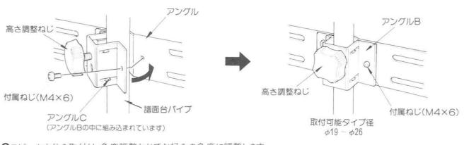
❸スピーカ本体を取付け、角度調整ねじでお好みの角度に調整します。
