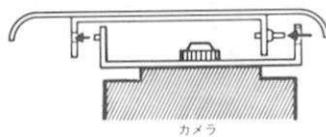
6. ハウジングを固定します。屋内水平垂直回転台には、ハウジング取付用ねじが4個付属されています。
