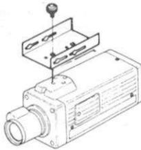
4. 使用するレンズにより、アングル固定板の位置を移動します。出荷時はAに固定されています。
