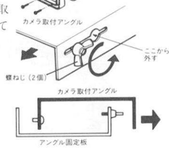
3. カメラをカメラ取付アングルに付属のねじで固定します。(絶縁スペーサを付属のねじに差し込んで下さい。)
