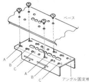
5. カメラ取付アングルをアングル固定板に固定します。
