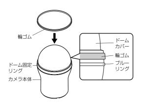
3 手順2で外した防滴パッキンをスモークドームカバーに取り付け、カメラ本体にかぶせます
