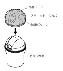
ドーム固定リングを左方向に回して取り外したあと、ドームカバーをカメラ本体から外して防滴パッキンを取り外します
