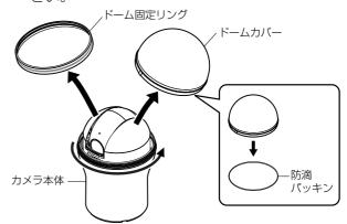
4 手順2で外したドーム固定リングを元に戻し、右方向に回してブルーリングが回転しなくなるまでしっかりと締め込みます
