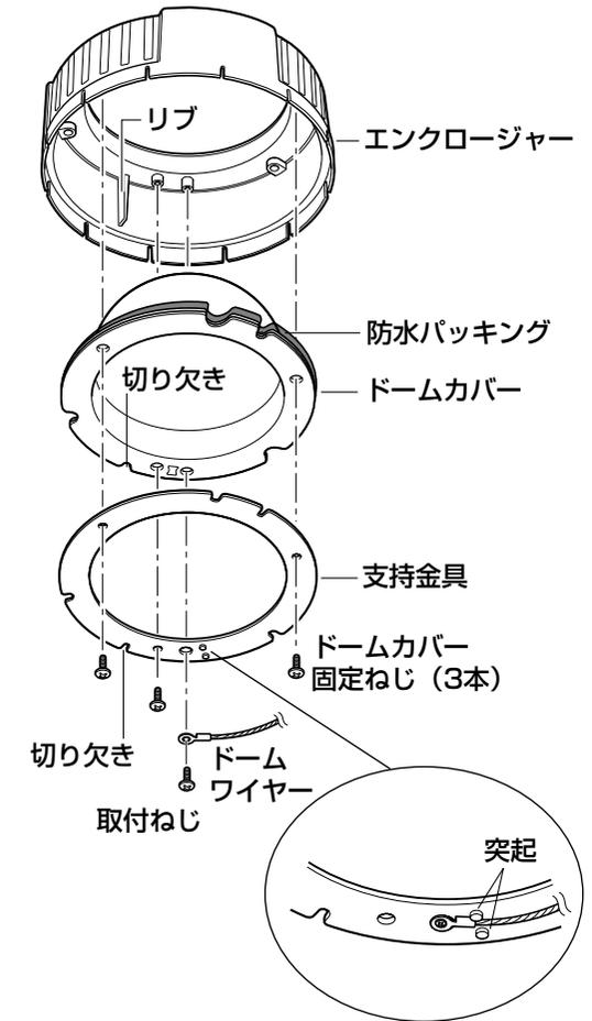
4. ドライバービットを使って、カメラ本体とエンクロージャーをエンクロージャー固定ねじ3本で取り付けます。
