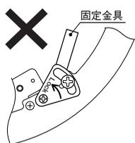
ロックプレートがロック位置まで動かないときは、カメラがしっかりセットされていない可能性があります。カメラが正しく取り付けられているか確認してください。
