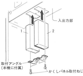
2 ワイヤレスチューナユニットWX-D300Cシリーズを差し込み、取付ア ングルで固定します。
