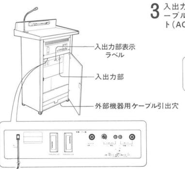
3 入出力部の電源コードを外部機器用ケーブル引出穴から引き出してコンセント(AC100V 50/60Hz)に接続します。
