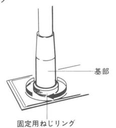
2 固定用ねじリングを矢印方向に回してテーブルマイクを固定します。
