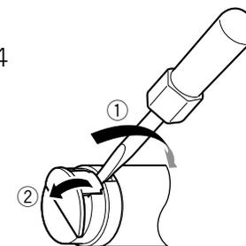
※底面キャップは電源スイッチ誤操作防止のため、取り外しにくい構造になっています。取り外す際は、必ず工具などを使用してください。
