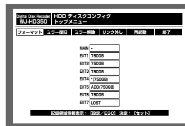
<デジタルディスクレコーダーのディスクコンフィグメニュー (RAID5) >
