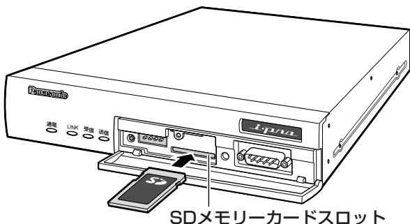
2 SDメモリーカードカバーのねじをゆるめ、ふたを取り外します。
