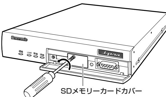
4 SDメモリーカードカバーを取り付けて、ねじをしっかりと締めます。
