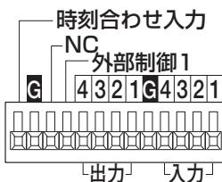
接続時は、外皮を約9 mm～10 mm切断し、ショートなどがないように芯線をよくよじってから接続してください。
