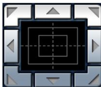
: 画像の水平位置・垂直位置の調節 (パン・チルト) はパッドおよびボタンを左クリックして行います。
