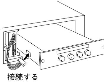
本機を途中まで組み込み、接続コネクタ(付属品)の片側を接続します。
