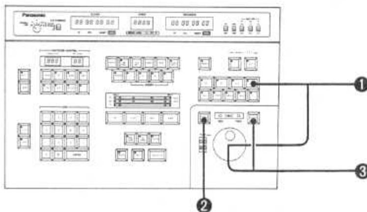
① VTR選択部のR keyを押した後、サーチダイヤル(ジョグ/シャトルダイヤル)でRECORDER側VTRの記録開始点(IN点)をさがします。
