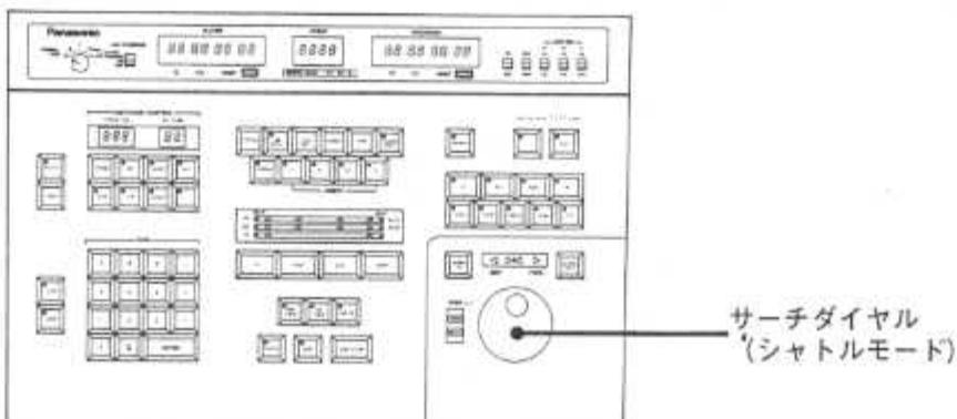
サーチダイヤルを回すとコントロールパネル部のPLAYER側ディスプレイの表示が[SP d:50]、[SP d:200]のように変わります。「50」は標準速度の50%( $\frac{1}{2}$ 倍速)、「200」は200% (2倍速)を示します。同時にVTRが表示に対応した速度でテープを再生します。
