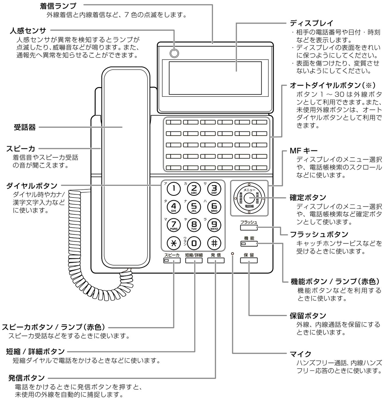
(※)多機能電話機には、30個の外線・オートダイヤルボタンを持つ機種と18個の外線・オートダイヤルボタンを持つ機種があります。2つの機種は、外線・オートダイヤルボタンの数以外の使いかたは同じです。上図は、30個の外線・オートダイヤルボタンを持つ機種(機種名:MKT/ARC-30DKHF/P-W-02A)の絵です。
