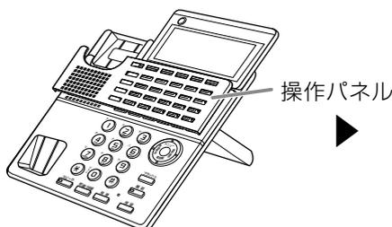
3. 操作パネルのツメ(6箇所)をそれぞれ矢印の方向に軽く押し込み、カチッと音がするまでツメをロックする
