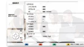
接続や接続機器に不具合がある箇所、または接続されていない機器がある箇所には「！」マークが表示されます。使用している接続機器が本体と正しく接続されているか、接続機器の電源が入っているか、バウンダリーマイクロホン（デジタルインターフェイスタイプ）が5台以上接続されていないか確認してください。
