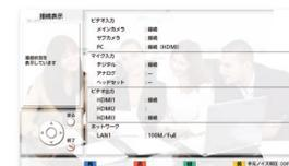
接続や接続機器に不具合がある箇所、または接続されていない機器がある箇所には「-」のマークが表示されます。使用している接続機器が本体と正しく接続されているか、接続機器の電源が入っているか、バウンダリーマイクロホン(デジタルインターフェイスタイプ)が5台以上接続されていないか確認してください。
