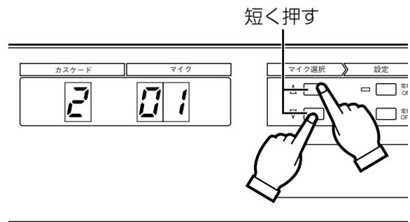
**3** 常時ON選択スイッチまたは常時OFF選択スイッチを押して、マイクの状態を設定する
