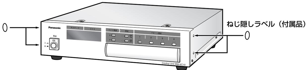
収納棚、または壁や天井などの付近に設置する場合は、本機の側面・天面から1 cm以上、後面からは5 cm以上離して設置してください（下図参照）。
