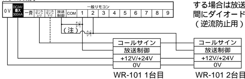
(注) 単局リモコン複数台で各ブロック放送する場合は放送制御と一般リモコン端子間にダイオードを接続してください。(逆流防止用)
