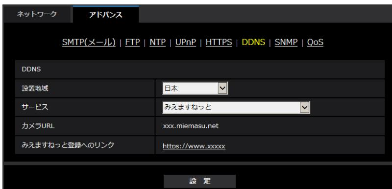
**5** カメラの画面を再度表示し、「カメラURL」に「みえますねっと」サービスに登録したドメイン (xxxx.miemasu.net:xxx) が表示されていることを確認します。
