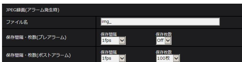
「録画圧縮方式」が「JPEG(1)」、「JPEG(2)」、「JPEG(3)」に設定され、かつ、「保存モード」が「アラーム発生時」に設定されている場合のみ設定できます。
