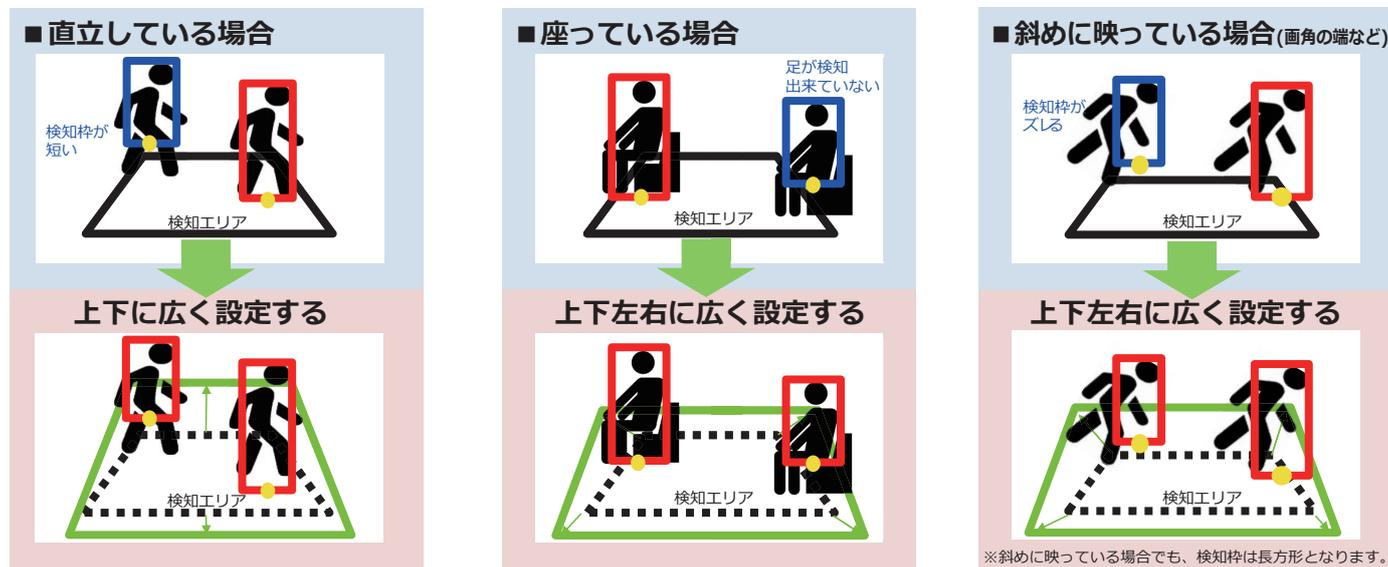
※検知エリア内判定されている検知枠は「赤」、検知エリア外判定されている検知枠は「青」で示してあります。
