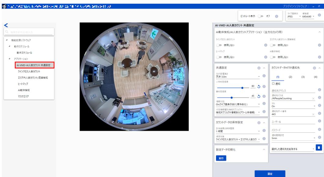
カメラ設定画面の「機能拡張ソフトウェア」メニュー→「AI-VMD・AI人数カウント 共通設定」メニューをクリックすると、AI動体検知/AI人数カウントアプリケーション（全方位カメラ用）の設定画面が開きます。
