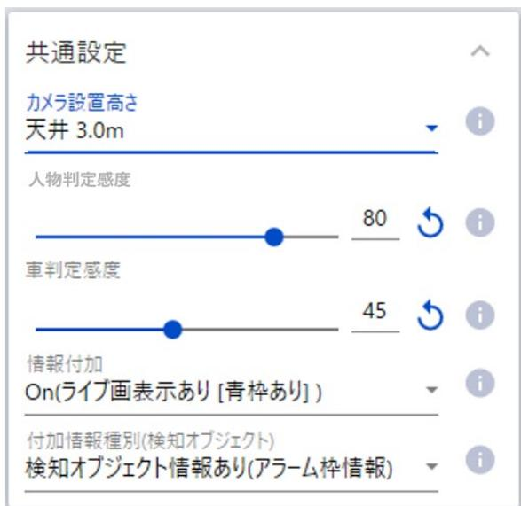
AI動体検知、ラインクロス人数カウント、ヒートマップ、エリア内人数カウント、混雑検知に共通する設定を行います。
