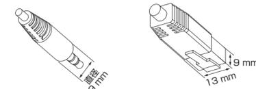
音声ケーブルコネクタ例 Ethernetケーブルコネクタ例
