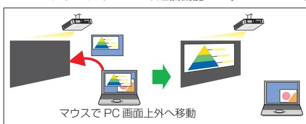
コンピューター画面とプロジェクター画面をマルチモニターに設定し、コンピューター画面をプライマリーモニター、プロジェクター画面をセカンダリーモニターとして使用します。コンピューター画面に参考資料を表示しながら、プロジェクター画面でプレゼンテーションを行う場合に便利です。
