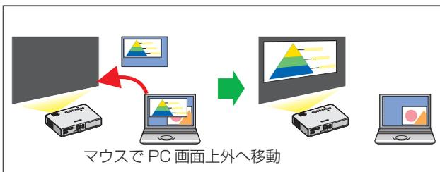
コンピューター画面とプロジェクター画面をマルチモニターに設定し、コンピューター画面をプライマリモニター、プロジェクター画面をセカンダリーモニターとして使用します。コンピューター画面に参考資料を表示しながら、プロジェクター画面でプレゼンテーションを行う場合に便利です。
