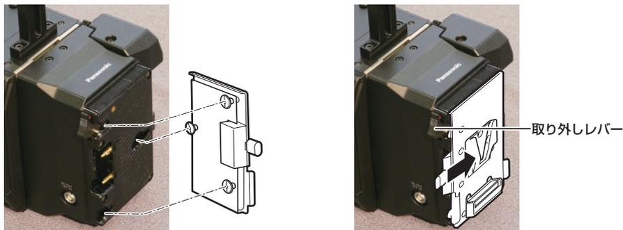
1 V マウントタイプバッテリープレートを取り付ける。
