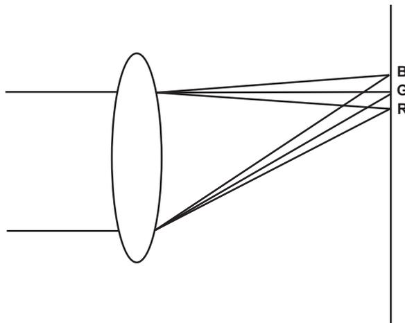
ここで言う色収差とは倍率色収差です。倍率色収差は、レンズの屈折率が赤 (R)・緑 (G)・青 (B) によって異なるために発生します。レンズ自体で色収差を補正しますが、特に周辺では色収差が残留します。また、この色収差は、ズームレンズであればズーム倍率・絞り・焦点距離が複雑に関係して発生します。画像としてはレジストレーションエラーとなります。
