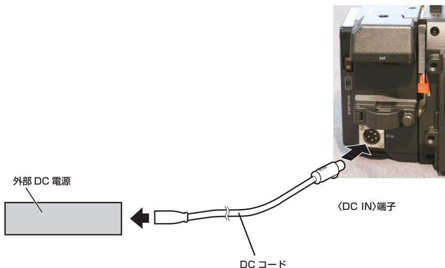
1 カメラ延長モジュールの〈DC IN〉端子と外部 DC 電源を接続する。
