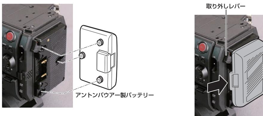
**1** アントンパワー製バッテリーを取り付ける。
