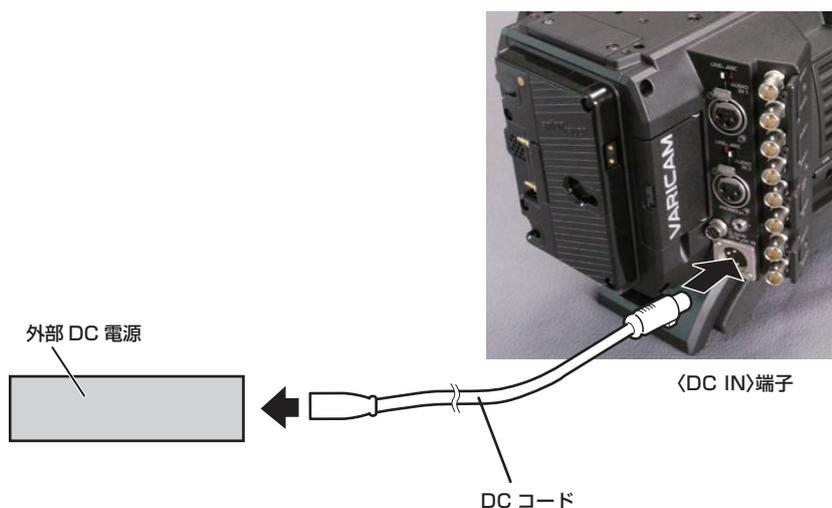
1 本機の〈DC IN〉端子と外部 DC 電源を接続する。
