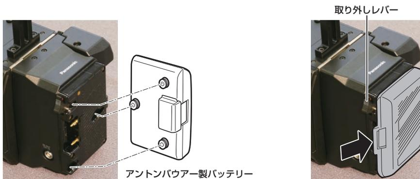
**1** アントンパワー製バッテリーを取り付ける。
