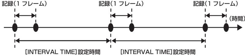
1 [MENU] → [REC SETTINGS] → [REC FUNCTION] → [REC MODE] で [INTERVAL] に設定する。
