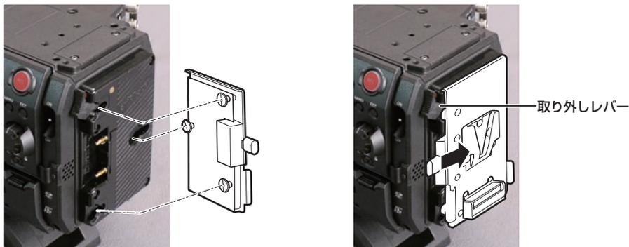
1 V マウントタイプバッテリープレートを取り付ける。
