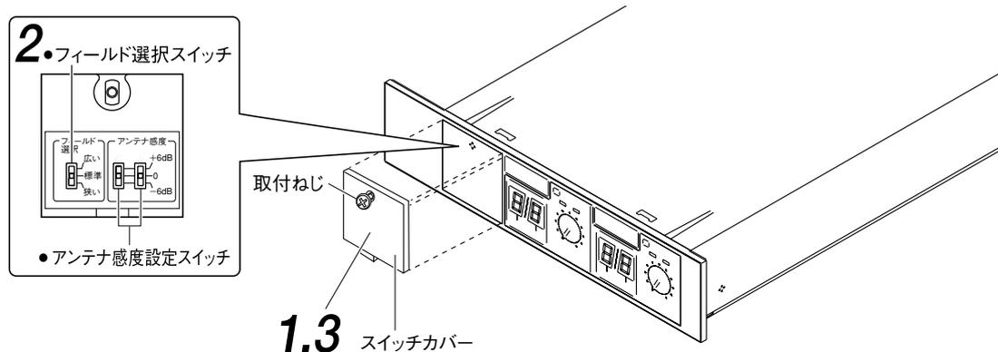
**1** 取付ねじ（1本）をゆるめて、スイッチカバーを外します。
