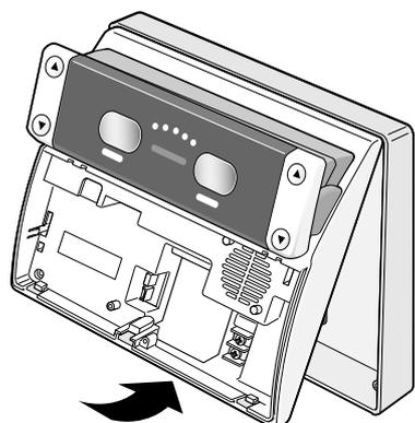
③ 本機取付ねじを底部に締め付け、本機を後面ケースにしっかりと固定します。
