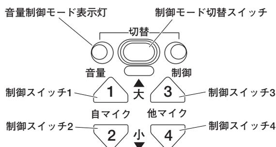
**1** 制御モード切替スイッチを1回または2回押して、音量制御モード表示灯を点灯（緑）させ、音量制御モードにします。
