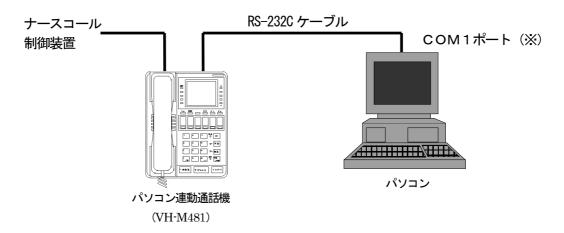
(※) タッチパネルディスプレイのコントローラーをシリアルポートに接続する場合は、COM1以外のポートを使用してください。
