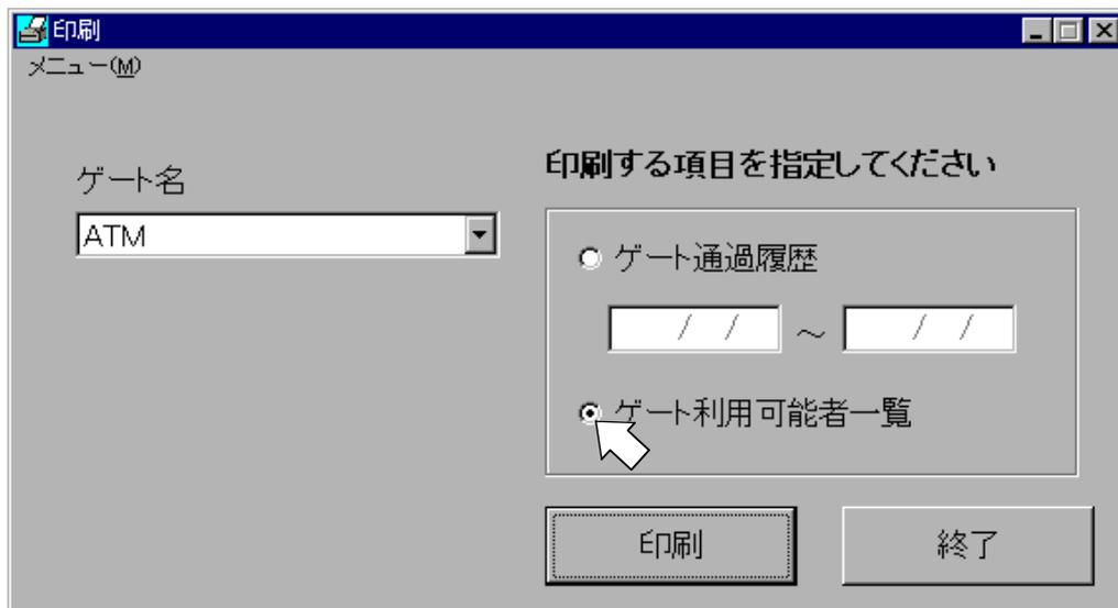
上の印刷画面で、「ゲート名」フィールドに印刷したいゲート装置を選択後、[ゲート利用可能者一覧] チェックボックスをオンにし[印刷]ボタンをクリックすることにより、その日に照合可能なゲート利用可能者一覧が印刷されます。
