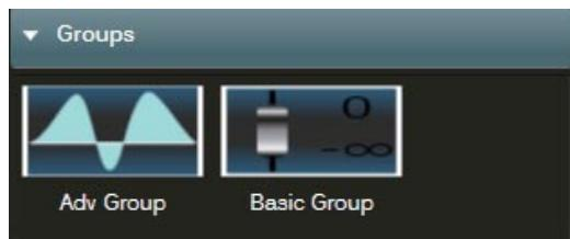
アドバンストグループには、[入力イコライザー設定] ボタン（ディレイ表示、位相状態表示）、入力イコライザーゲイン設定、[ミュート] ボタン、[Assign] ボタンがあり、ベーシックグループには、[Details] ボタン、出力減衰設定、[ミュート] ボタン、[Assign] ボタンがあります。
