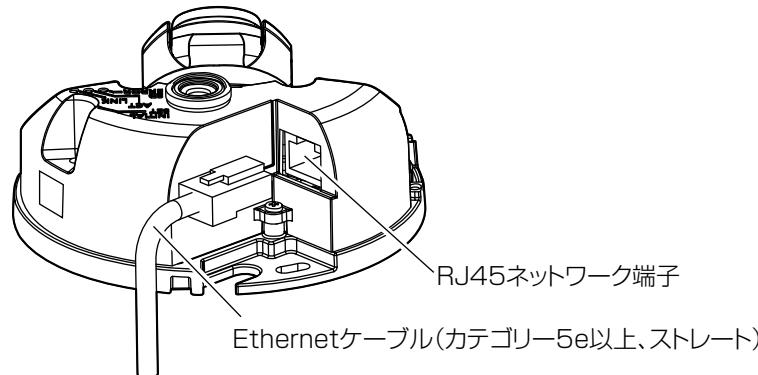
RJ45ネットワークケーブルまたはRJ45ネットワーク端子にEthernetケーブル（カテゴリー5e以上、ストレート）を接続します。
