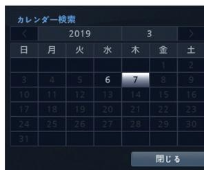
録画映像がある日付は、強調表示されます。十字ボタンでカーソルを移動させ [再生/一時停止] ボタンを押して選択するか、マウスで直接選択します。選択した日付の最初の録画画像が静止画像で表示されます。検索したい日付を選択したら、「録画テーブル検索」画面の下の再生ボタンで、前後の映像を確認します。
