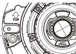
イラストは電源用端子台、外部I/O用端子台がカメラに取り付けられている状態です。
