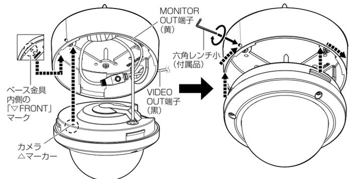
[6] エンクロージャー部分を取り外し、HDアナログカメラ駆動ユニットの電源を入れる。
