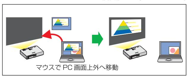
コンピューター画面とプロジェクター画面をマルチモニターに設定し、コンピューター画面をプライマリーモニター、プロジェクター画面をセカンドリーモニターとして使用します。コンピューター画面に参考資料を表示しながら、プロジェクター画面でプレゼンテーションを行う場合に便利です。
