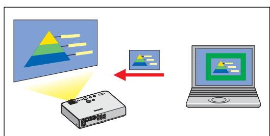
コンピューターで表示されている画面のうち、必要な情報のみをエリア指定ウィンドウで指定し、投写画面に表示することができます。
