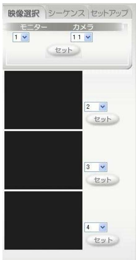
「モニター」欄の ▾ をクリックし、カメラ映像を表示させたいモニターを選択します。「カメラ」欄の ▾ をクリックし、表示したいカメラCHとカメラタイトル（先頭7文字まで）を選択します。「セット」をクリックすると、選択したモニターにカメラ映像が表示されます。
