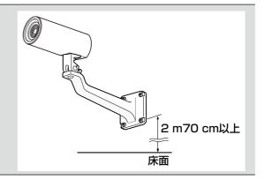
2 カメラをカメラ取付台(天井用)WV-7010A(別売り)に取り付ける場合は、天井取付台用スペーサー(付属品)を使用して取り付けてください。
