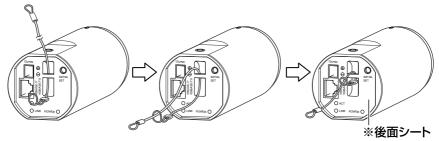
①落下防止ワイヤー(付属品)の輪の部分をワイヤー取付穴に通します。
