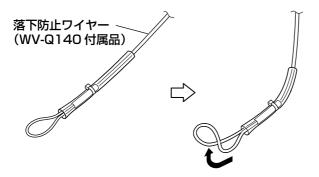
2 落下防止ワイヤー(WV-Q140付属品)をワイヤー取付穴に取り付けます。
