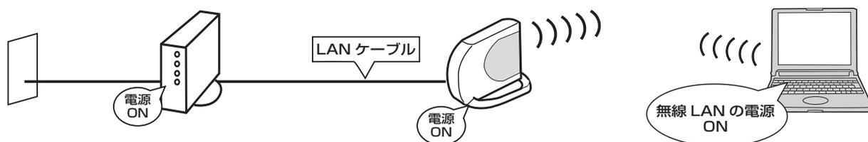
1 無線LANアクセスポイントとブロードバンドモデムをLANケーブルで接続する。
