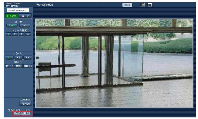
[RS485操作画面]を「On(回転台制御)」に設定した場合、ライブ画ページにリンクが表示されます。 リンクをクリックすると、回転台を制御する画面が別ウィンドウで表示されます。
