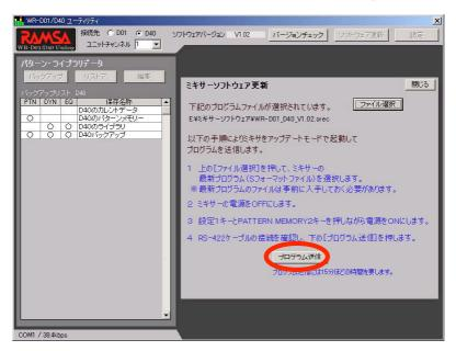
※手順⑥で電源ONしたミキサーの終端スイッチを切り換える場合は、いったん電源をOFFにしてから切り換えてください。その後再度⑦の手順で電源をONします。
