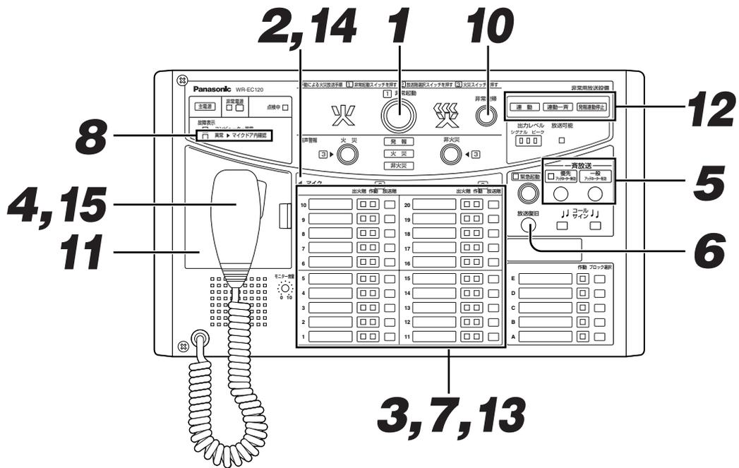
**1** 手で非常起動スイッチを押します。火災灯が点滅し、放送階選択指示灯が点滅しますか？
