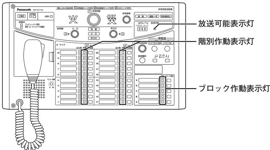
※放送階選択スイッチが押され、表示灯が上記以外の状態になると、マイク音声は選択された階へ放送されます。
