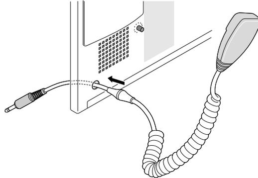
②マイクロホンプラグをCPU基板のマイクロホンジャックに接続します。
