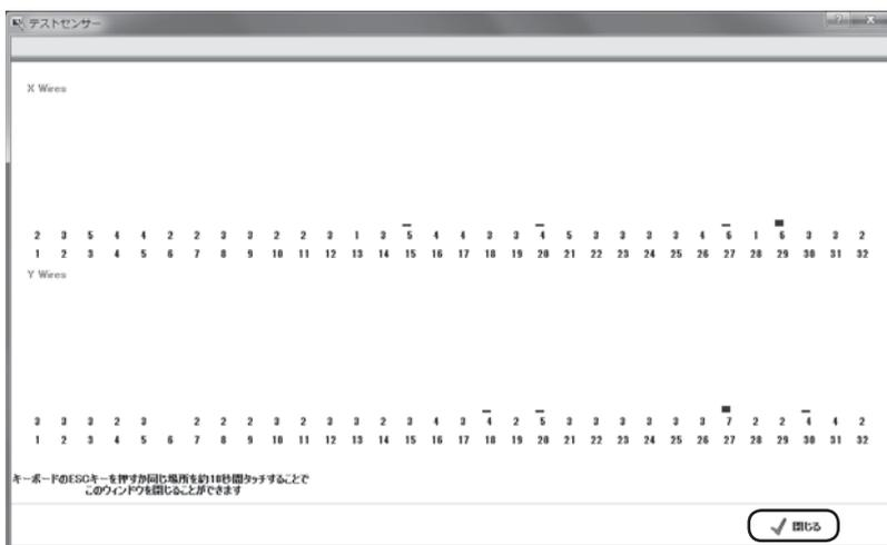
テストセンサー画面が起動し、X軸とY軸のワイヤセンサーレベルを表示する画面になります。タッチパネルのセンサーに触れることにより、X軸とY軸のワイヤセンサーレベル値が応答します。
