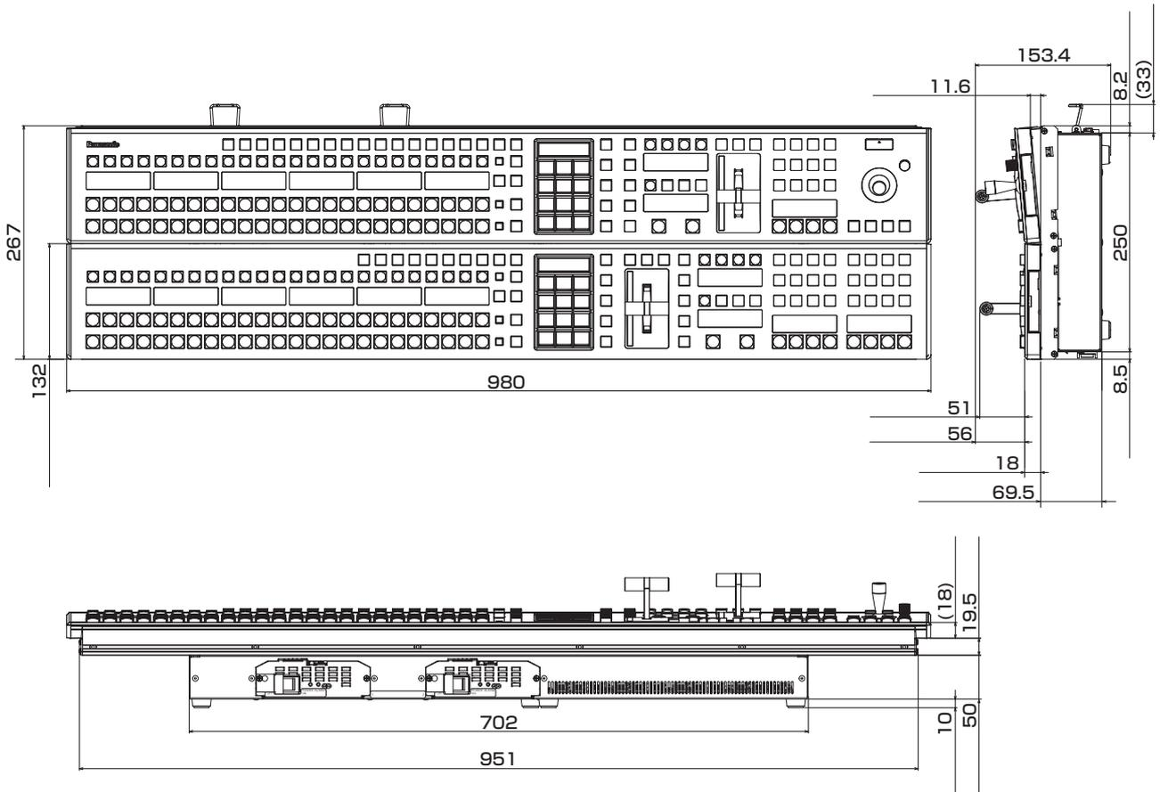
コントロールパネル AV-HS60C4 の外形寸法図
