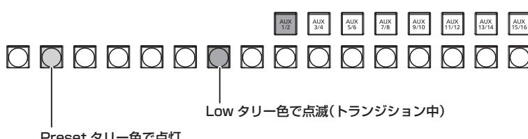
[AUX Trans] コラムの [AUX1] ~ [AUX4] で [On] に設定している場合、該当する KEY バスクロスポイントボタンが切り替える素材信号を選択します。
