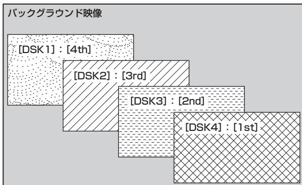
**1 <DSK MISC> ボタン → [MISC] → [Misc] タブを選択する****2 [DSK Priority] コラムの [DSK1] ~ [DSK4] で項目を選択する**
