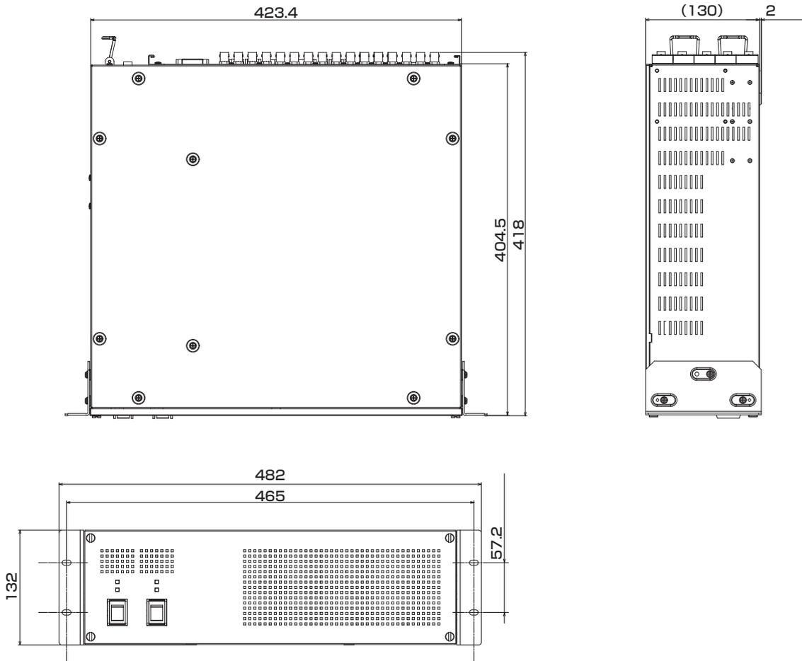
コントロールパネル AV-HS60C1/AV-HS60C2 の外形寸法図
