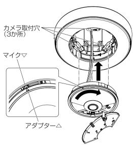
③ケーブルを収納しながらマイクのカメラ取付穴に カメラ裏側のアタッチメント固定ねじをひっか け、矢印の方向にカメラを回して仮固定します。
