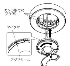
**④カメラ固定ねじを締めてカメ** ラを固定します。
