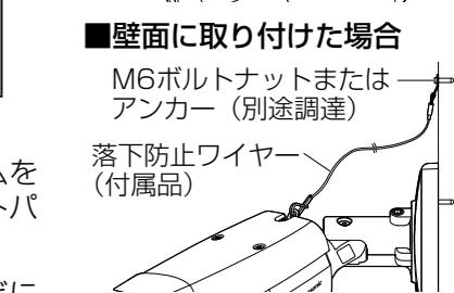
M6ボルトナットまたはアンカー (別途調達) 落下防止ワイヤー (付属品)
