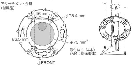
※1 設置時にカメラの取付方向が決まっていない、設置後にカメラの向きを変更する場合 カメラの向きを変更する場合は、中心にφ73 mmの穴をあけます。90°単位 でカメラ取り付けの方向を変更できます。
