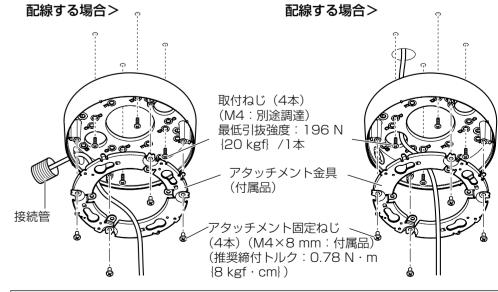
●ケーブルを露出配線する場合は、必ず接続管を使用して、ケーブルに直射日 光が当たらないようにしてください。
