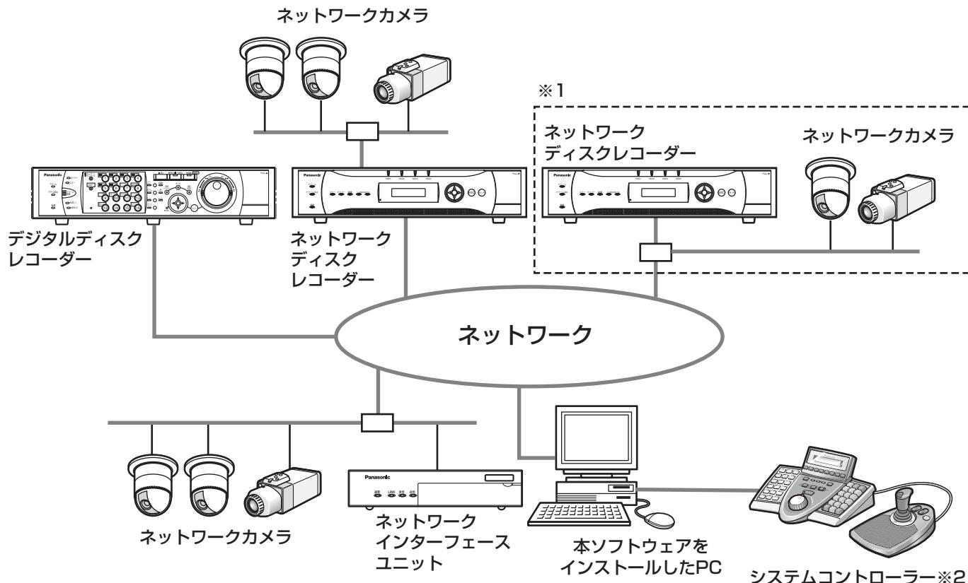
※1 点線で囲まれた構成にすると、レコーダーに接続されているカメラの画像を、レコーダーを経由せずに直接見ることができます。その場合、以下の項目を確認・設定してください。
