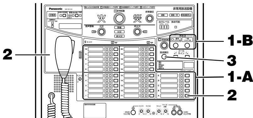
**1-A** 放送したい場所の放送階選択スイッチまたは、ブロック選択スイッチを押します。
