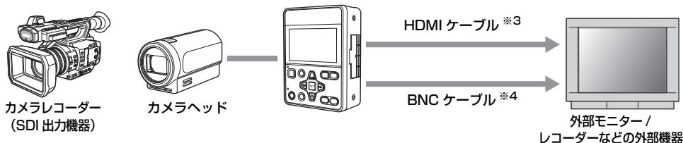
\*3. 市販の HDMI ケーブルは、High Speed HDMI ケーブルをご使用ください。なるべく 3 m 以内のケーブルのご使用をお勧めします。
